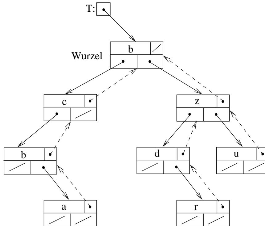
Erleichtert Navigieren im Baum, besonders bei Verwenden von iterativen Verfahren.
